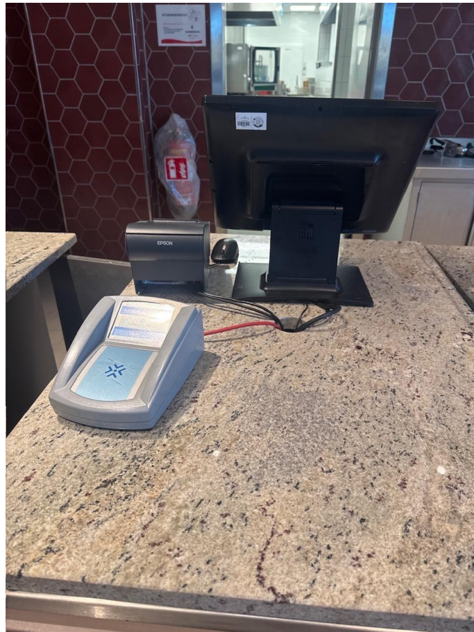
Abbildung 5: Kassenarbeitsplatz Campus Gebäude Zweitkantine– Touch-Display, Bondrucker, Kartenleser
