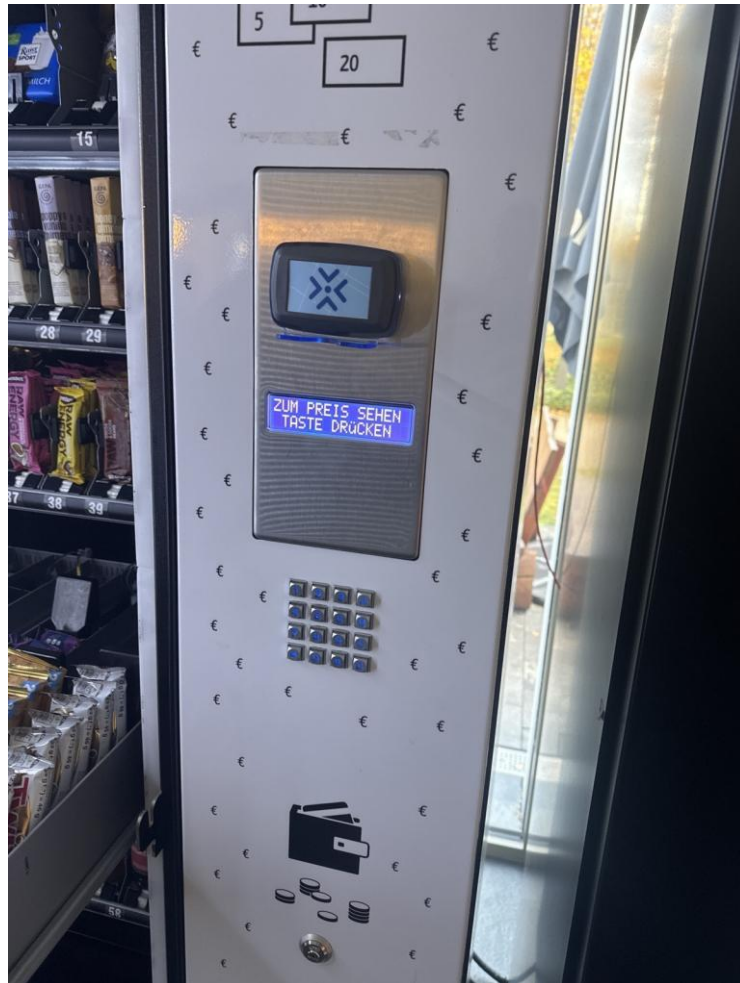
Abbildung 7: Snackautomat mit Bedienleiste und Bezahl-Terminal
